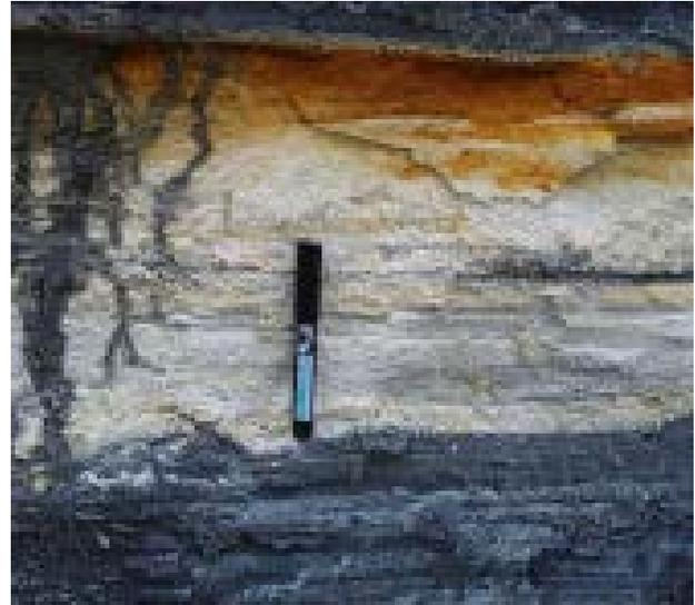
FIGURE 5 > PRÉSENCE D'UNE OXYDATION ET D'UN « HARDPAN » AU SEIN D'UNE COUCHE SABLEUSE PERMÉABLE SOUS UNE COUCHE DE RÉSIDU ARGILEUX ET PYRITEUX PEU PERMÉABLE, AU SEIN D'UNE HALDE À RÉSIDUS DE FLOTTATION. (PHOTO PERSONNELLE DE L'AUTEUR DU PRÉSENT RAPPORT) Ce phénomène résulte de la non saturation de la couche sableuse et il est significatif que ce phénomène se produit sous et non sur la couche pyriteuse.
